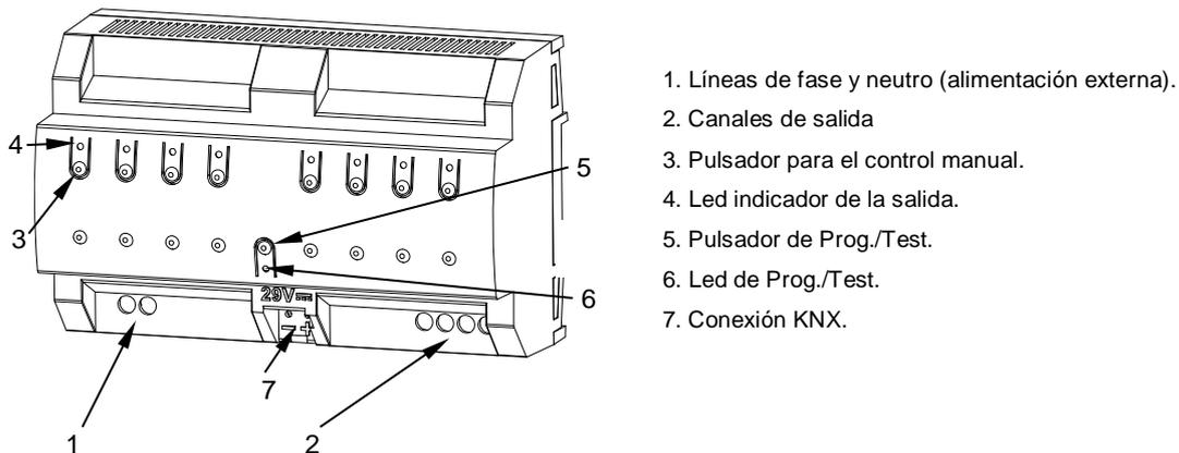
Figura 5 DIMinBOX DX4 – Diagrama de elementos.
