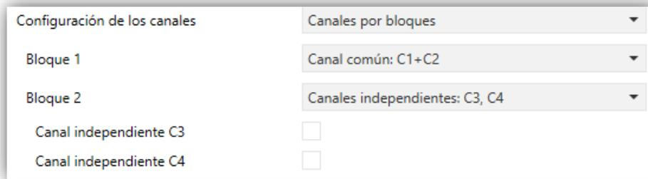
Figura 8 Configuración de canales por bloques en DIMinBOX DX4.
