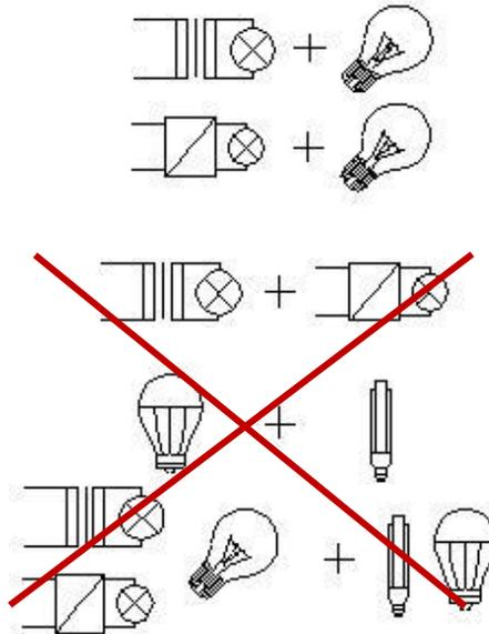
Figura 2 Combinación de tipos de carga.
