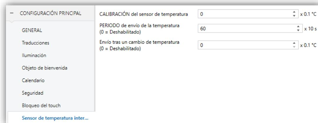
Figura 48 Sensor de temperatura interno (Configuración principal)
