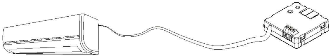
Figura 2. Conexión del KLIC-MITT v2 a la máquina de A/A
