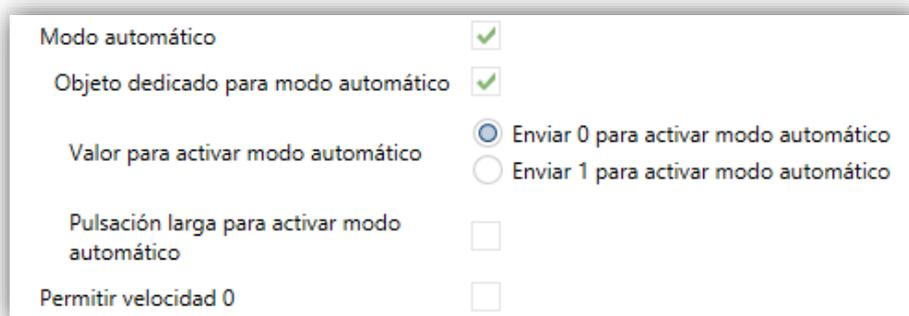
Figura 57. [Climatización] Ventilador – Objeto dedicado para modo automático.
